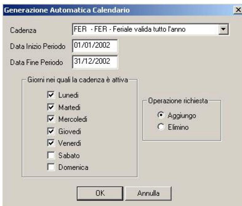
Il pannello di generazione automatica del calendario consente di registrare una cadenza su tutta una serie di giorni come da filtro di selezione impostato; nell'esempio fornito la cadenza feriale viene automaticamente aggiunta su tutti i giorni dell'anno con esclusione dei Sabati e delle Domeniche.
